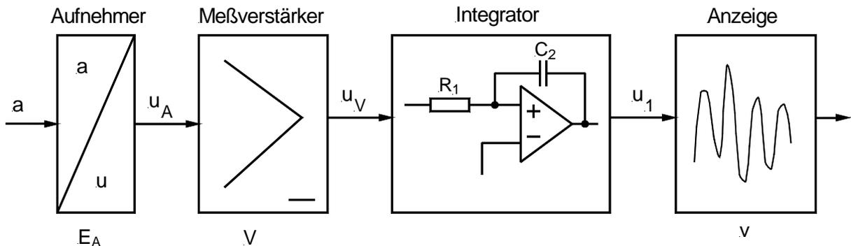
Der Beschleunigungsaufnehmer hat eine Meßempfindlichkeit von  $E_A=0,2\text{mV/g}$ . Der Meßverstärker hat eine Linearverstärkung von  $V=500$ . Der elektronische Integrator hat einen Eingangswiderstand von  $R_1=1\text{M}\Omega$ . Bei einer Nennbeschleunigung von  $10g$  ( $1g=9,81\text{m/s}^2$ ) sollen innerhalb der Nennspannung von  $u_1=10\text{V}$ , Geschwindigkeiten bis  $100\text{m/s}$  sensiert werden.
