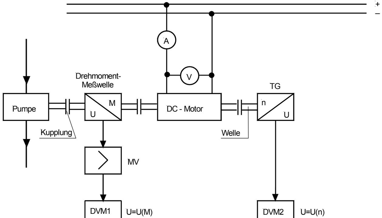
Die zugeführte elektrische Leistung  $P_{zu} = U I$  wird über eine Strommessung und eine Spannungsmessung, mit einem analogen Ampere-Meter A und einem analogen Volt-Meters V, bestimmt.
